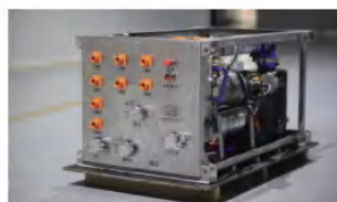
氢能发电模块单元（综合模块）1135*660*591mm
