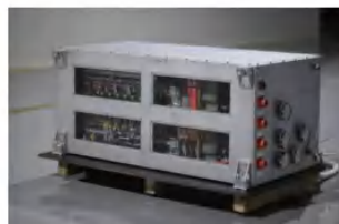
氢能发电模块单元（电堆模块）1150*660*476mm
